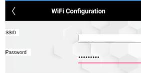
Después de ingresar el SSID y la contraseña, el usuario puede enviar la configuración de wifi al módulo de puerta de enlace inalámbrico. Si se realiza correctamente, la LUZ LED DE MODO (D, Figura 1) será de color azul oscuro. Si no se realiza correctamente, la LUZ LED DE MODO (D, Figura 1) será de color rojo. Intente nuevamente.
